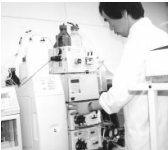
改正水道法に対応して導入したイオンクロマトグラフ・ポストカラム(本会)
